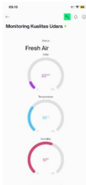
Gambar 14. Dashboard Monitoring Kualitas Udara pada Blynk
