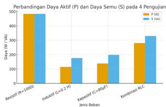
Gambar 3. Grafik Hasil Pengujian Daya Beban RLC
