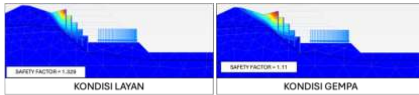
Gambar 5 Hasil pemodelan penanganan galian dengan secant pile desain kedua menggunakan PLAXIS
