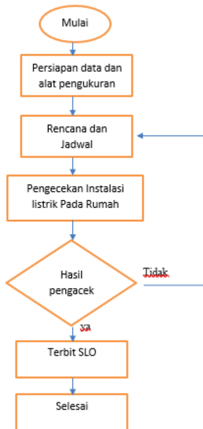
Gambar 1. Proses Pengecekan instalasi listrik pada Rumah
