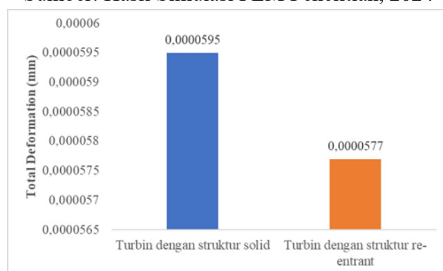
Gambar 23. Perbandingan nilai deformation pada rangkaian turbin setiap variabel
