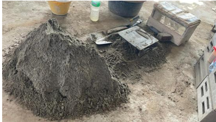
Gambar 1. Adukan kering Semen, Agregat dan air
