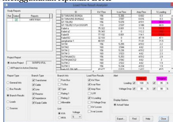
Gambar 9. Hasil simulasi pembebanan Trafo GT. TBL052 Setelah Pemasangan/ Pengalihan Beban ke Trafo sisipan menggunakan Aplikasi ETAP.
